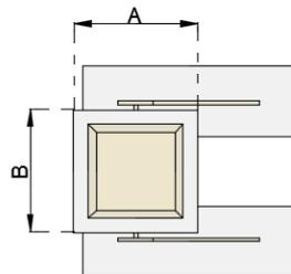
Papeleras fabricada de estructura de acero laminado de 3 mm de espesor S-275, con estructura principal de perfilaría de acero hueco laminado y chapa de hacer laminado, aplicando una imprimación antioxidante en toda la estructura (Minio) de acabado color gris, con posterior pintado con esmalte antioxidante de acabado liso en color a elegir según carta RAL en estructura principal que realiza la función de respaldo.
