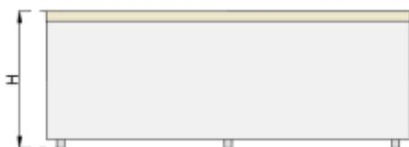
Macetero fabricado de estructura de acero laminado de 3 mm de espesor, aplicando una imprimación antioxidante en toda la estructura (Minio) de acabado color gris, con posterior pintado de remates con esmalte antioxidante de acabado liso en color a elegir según carta RAL.
