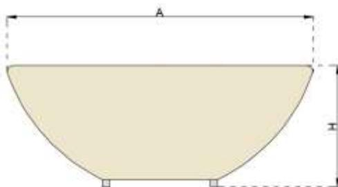
Macetero pre-fabricado de estructura de Hormigón armado con forma de semi-esfera, con posterior pintado con esmalte de pintura de poliuretano alifático de acabado en color a elegir según carta RAL.
