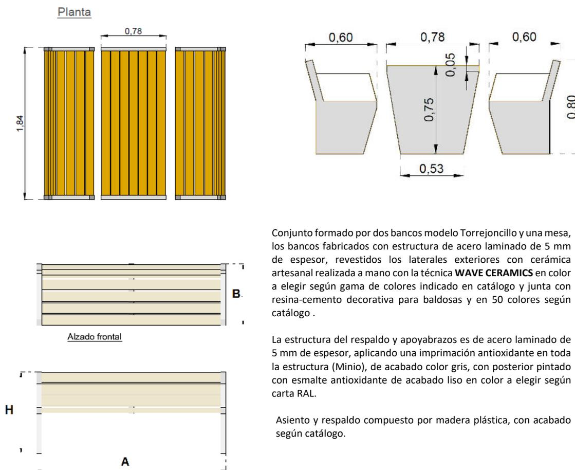
Conjunto formado por dos bancos modelo Torrejuncillo y una mesa, los bancos fabricados con estructura de acero laminado de 5 mm de espesor, revestidos los laterales exteriores con cerámica artesanal realizada a mano con la técnica **WAVE CERAMICS** en color a elegir según gama de colores indicado en catálogo y junta con resina-cemento decorativa para baldosas y en 50 colores según catálogo.
