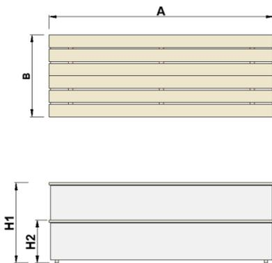
Banco fabricado con núcleo de Hormigón armado, Revestido por WAVE CERAMICS en color a elegir según gama de colores indicado en catálogo y junta con resina-cemento decorativa para baldosas y en 50 colores según catálogo.
