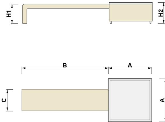
Banco y macetero fabricado de estructura principal de Hormigón Armado, revestido de WAVE CERAMICS en toda su superficie menos las caras inferiores del banco y del macetero.
